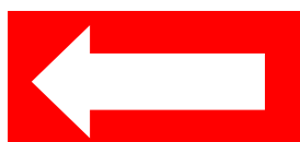
SMĚR K PROSTŘEDKU POŽÁRNÍ OCHRANY
